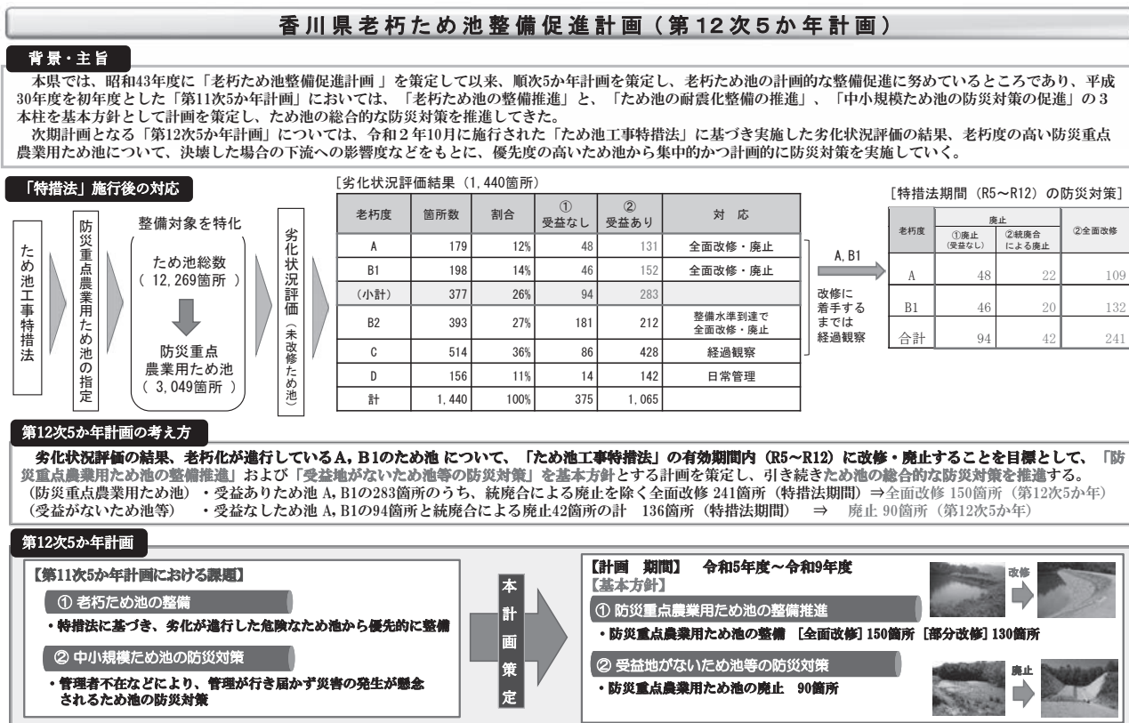
図7 香川県におけるため池工事特措法の有効期間内のため池防災対策
