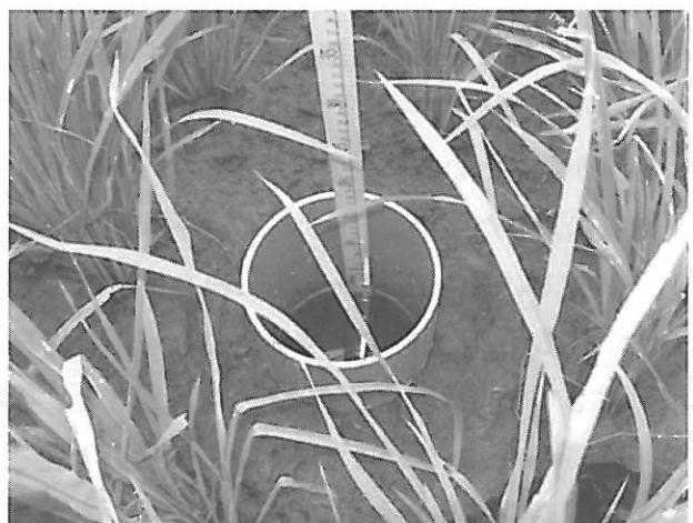
写真3－田面水位観測用チューブと定規による水位監視
