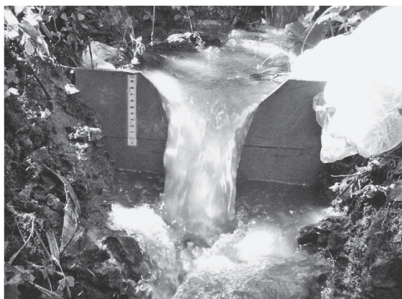
三角堰による漏水量調査の状況
